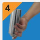
4 Se recomienda al término de la aplicación invertir el envase, presionar la boquilla por 5 segundos para purgar la válvula y dejar limpio el conducto de aplicación.
